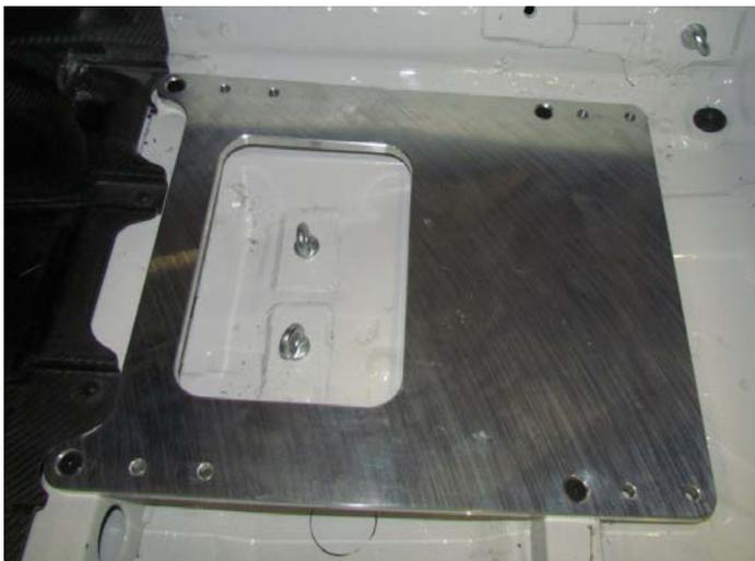
*Bild 3.3.2: Grundplatte Sitzbefestigung montiert auf Traverse Sitzbefestigung*
